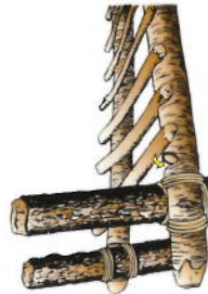
Einkerben der Unterkonstruktion
