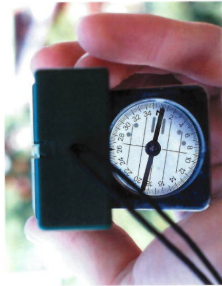
Peilen über Visiermarke und Korn mit Spiegel
