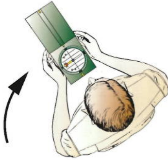
Solange mit Kompass drehen bis die Magnetnadel mit der Nordmarkierung übereinstimmt
